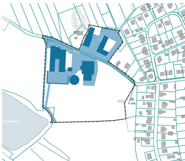
Abb. 4: bestehende Bebauung (dunkelblau - Hochbau, hellblau - Flächenversiegelung)
